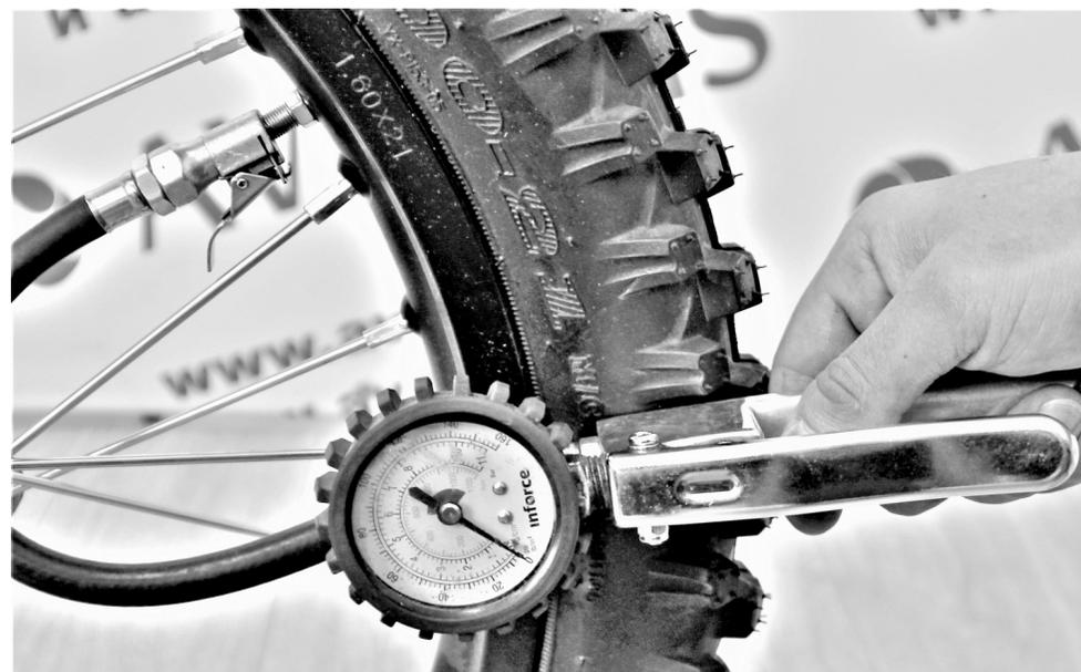
Устанавливайте передние и задние шины, только с одинаковым рисунком протектора!
