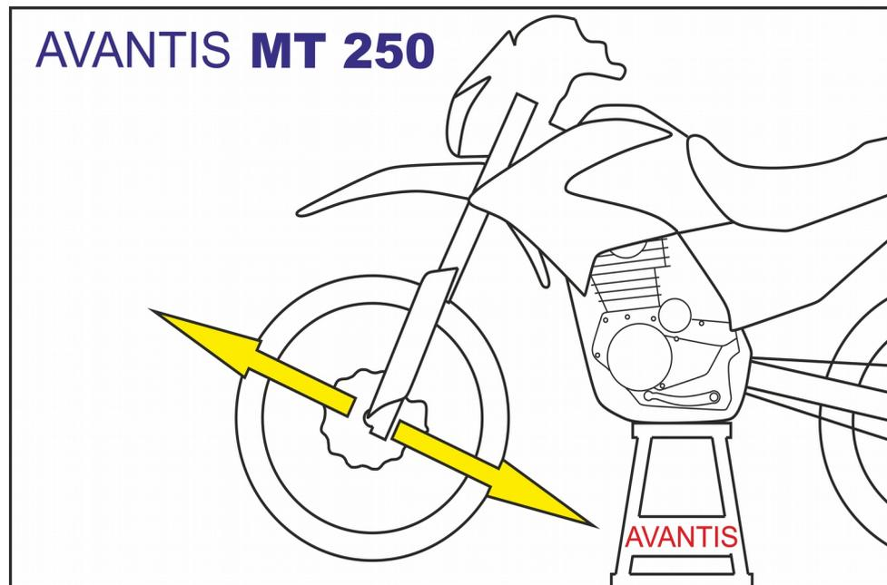
**Для регулировки** ослабьте болты [1] верхней траверсы и поверните по часовой стрелке гайку [3] до отсутствия свободного хода.
