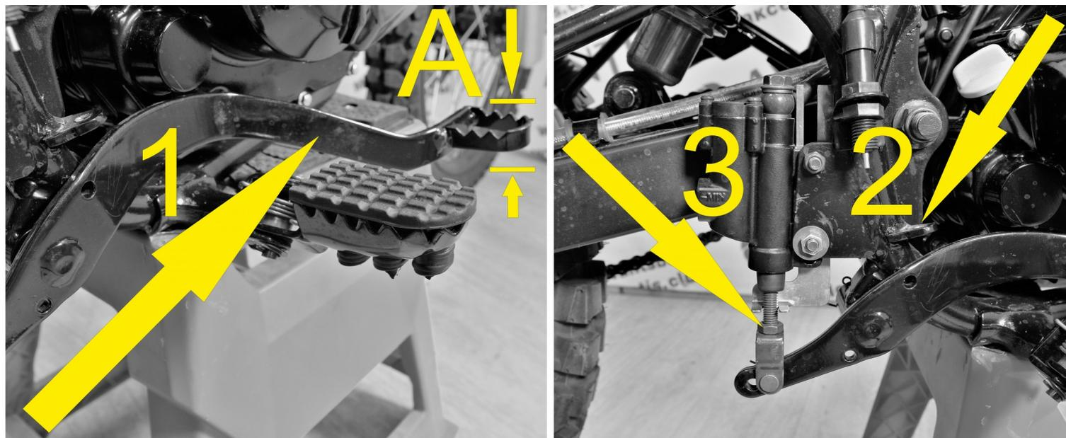
Свободный ход [А] педали заднего тормоза [1] должен быть 3-5 мм; прежде чем поршень начинает перемещение в тормозном цилиндре (**при нажатии Вы почувствуете более сильное сопротивление педали**).
